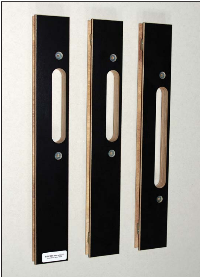
fig. 1 - Onderdelen van de freesmal - 2x bijzetkom, 1x hoofdkom
