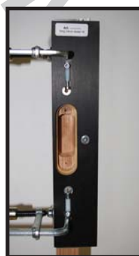
fig. 5 - Mal op deur
